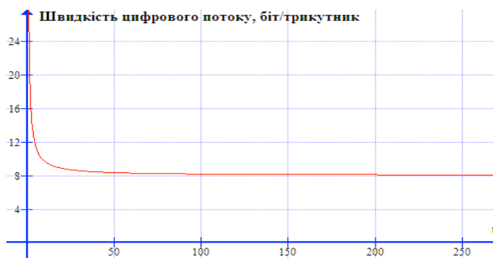
Рисунок 5 – Загальна залежність швидкості цифрового потоку (біт/трикутник) від кількості трикутників
