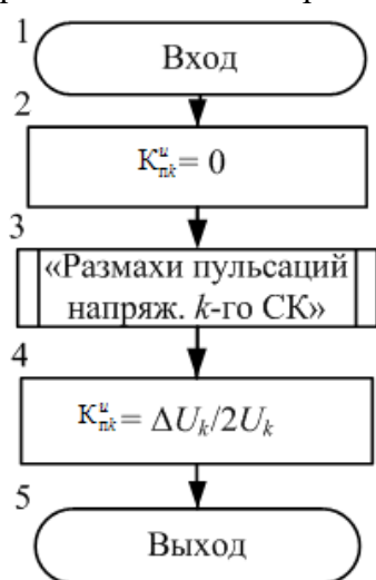
Рисунок 6 – Алгоритм подпрограммы «Коэффициенты пульсаций напряжения k -го СК расчёта коэффициентов пульсаций напряжений k -го силового канала СК
