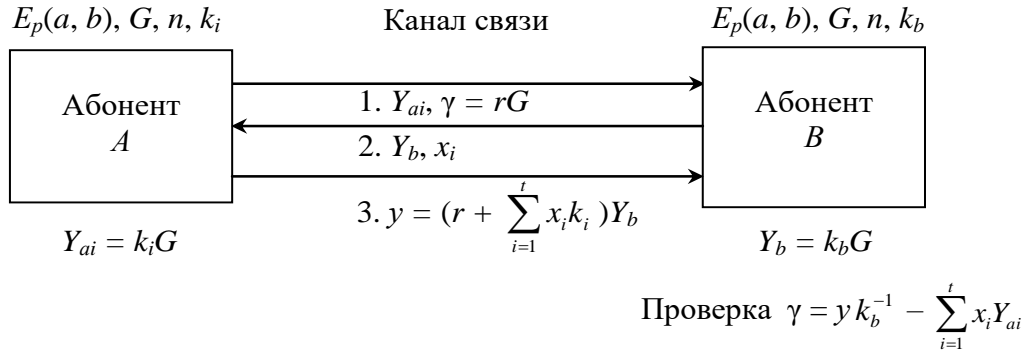
Рисунок 2 – Параллельная схема идентификации доказательства с нулевым разглашением на основе эллиптических кривых с использованием открытого ключа абонента B
