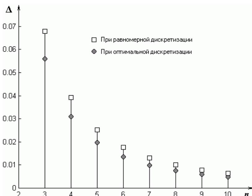
Рисунок 2 – Зависимость целевой функции от количества отсчетов при равномерной и оптимальной дискретизации
