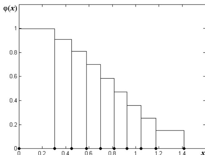
Рисунок 1 – График ступенчатой аппроксимации целевой функции
