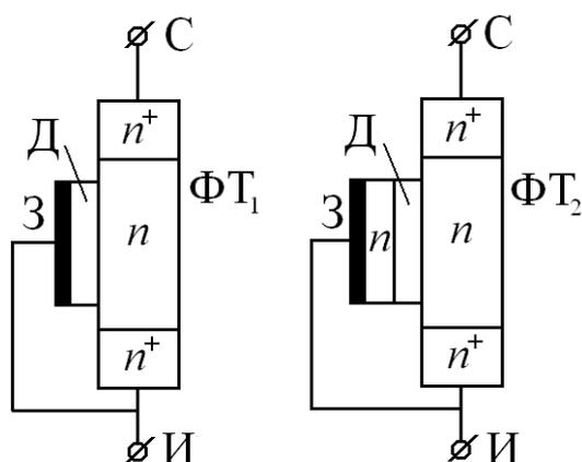
Рисунок 7 – Полевой МДП-транзистор со встроенным каналом (а), с полупроводником *n*-типа между затвором и диэлектриком (б)
