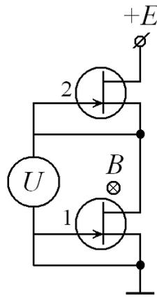
Рисунок 1 – Схема из двух полевых транзисторов: 1 – ПМТ; 2 – ПТ
