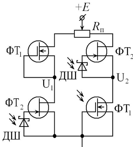
Рисунок 8 – Эквивалентная схема мостового фотодатчика
