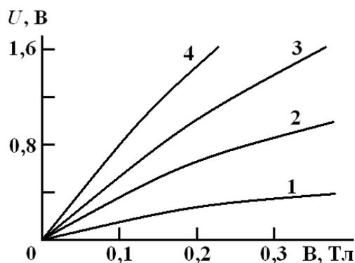
Рисунок 4 – Зависимость выходного напряжения от магнитной индукции.
