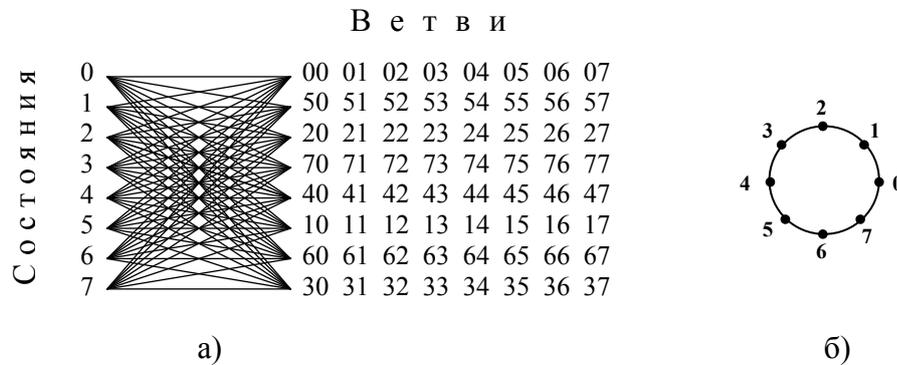
Рисунок 3 – Шаг решетчатой диаграммы (а) и сигнальное созвездие ФМ-8 (б) РСКК
