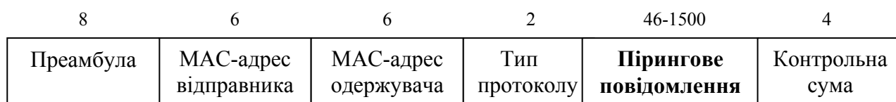
Рисунок 1 – Інкапсуляція пірингового повідомлення в кадр Ethernet
