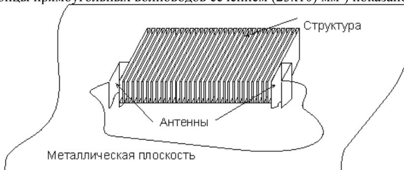
Рисунок 8 – Пример расположения плоской ребристой структуры
