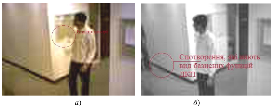
Рисунок 5 – Спотворення при стисненні, що впливають на вислідну суб'єктивну якість: а) розмиття кольорів; б) спотворення у виді базисних функцій ДКП
