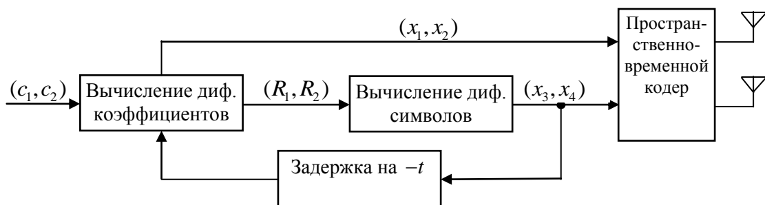
Рисунок 1 – Структурная схема дифференциального пространственно-временного кодера
