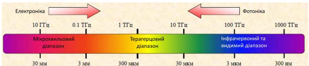
Рисунок 2 – Розміщення терагерцового діапазону в електромагнітному спектрі
