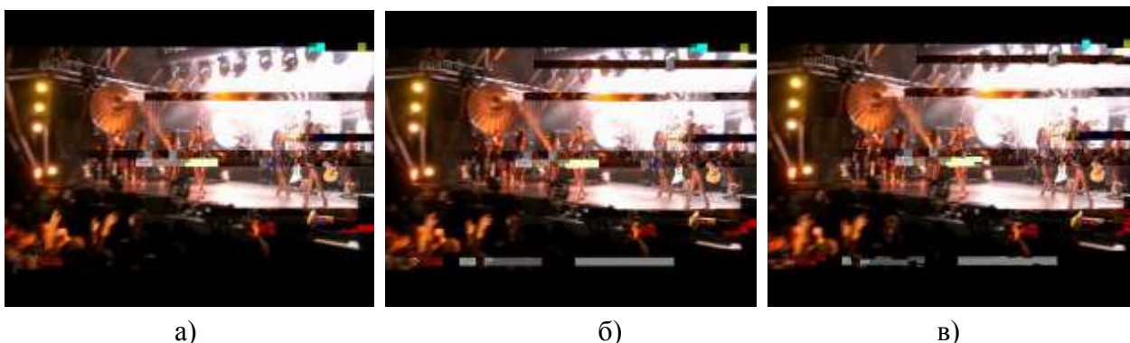
Рисунок 4 – Розподілення спотворень у часі в режимах з передбаченням: а) опорний кадр з помилками, б, в) P-кадри, відновлювані з опорного кадру
