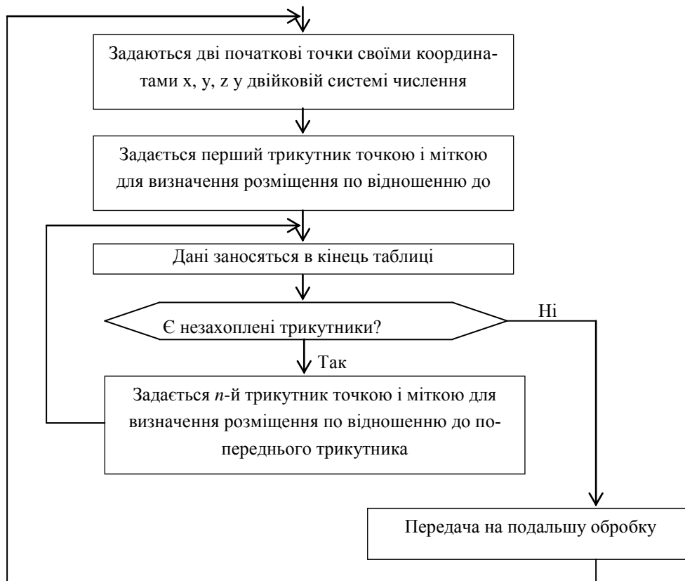
Рисунок 7 – Алгоритм кодування трикутної сітки зображення
