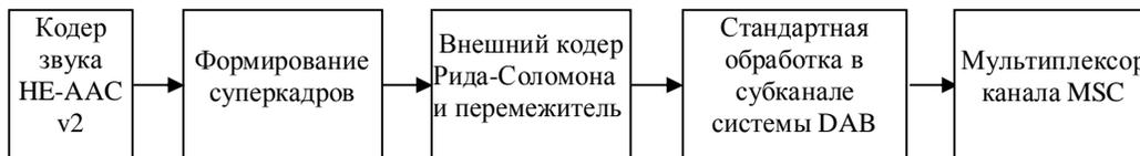
**Рисунок 2** – Применение внешнего кодера и перемежителя при формировании цифрового сигнала в системе DAB+
