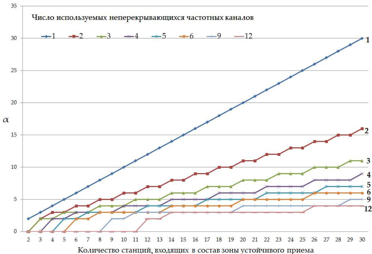
Рисунок 15 – Зависимость верхнего динамически управляемого порога \alpha от числа используемых частотных каналов и размера зоны устойчивого приема
