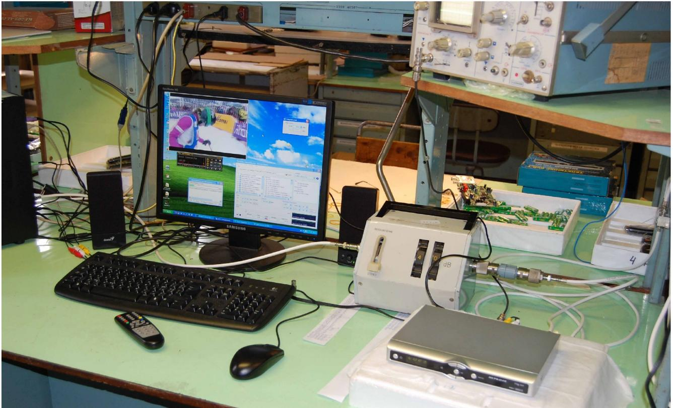
Рисунок 3 - Состав рабочего места регулирования и технического контроля цифрового телетюнера
