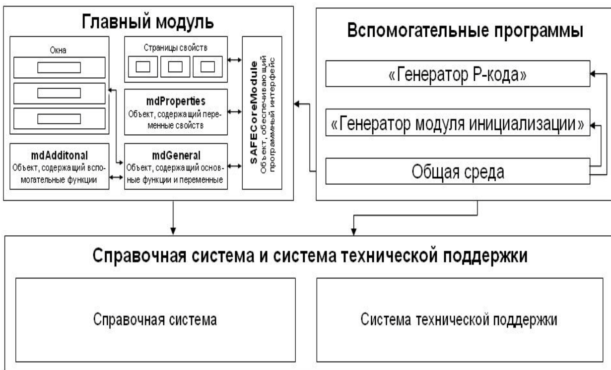
Рисунок 2 - Компоненты системы «Сейф»
