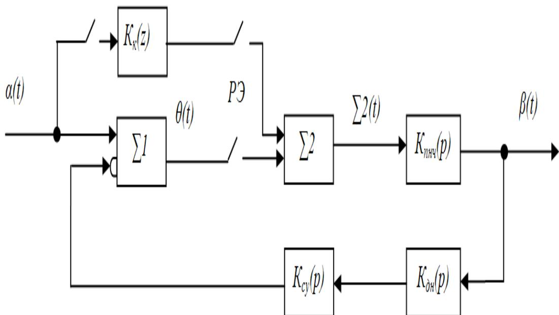
Рисунок 2 – Структурная схема ЦУМ с комбинированным управлением
