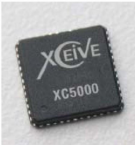
Рисунок 1. Высокоинтегрированный тюнер Xceive XC5000.
