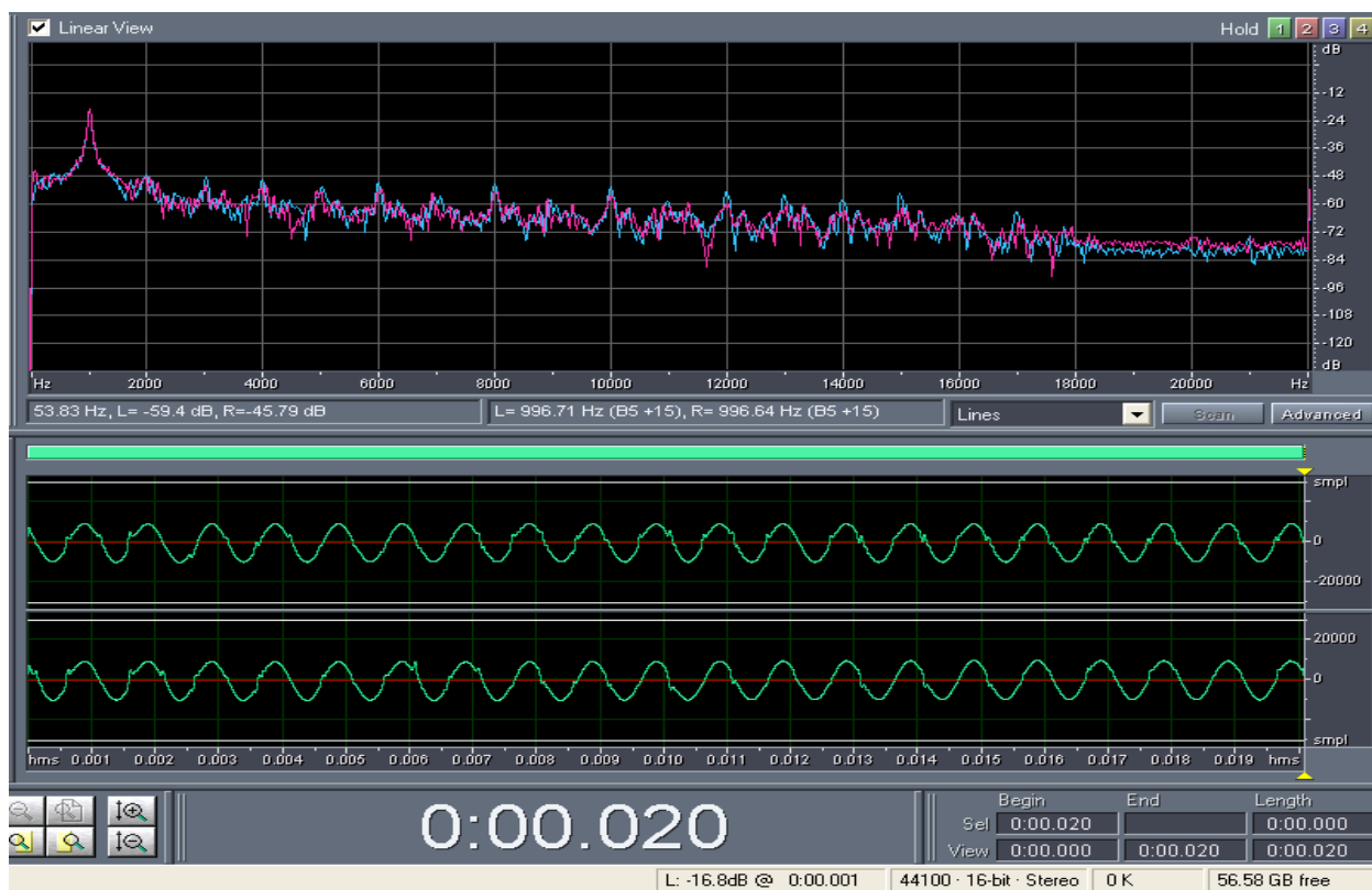
Рисунок 6 – Спектрограмма и сигналограммы сигналов, соответствующие пересечению участка зоны с меньшими искажениями в т. А за 20 мс.
